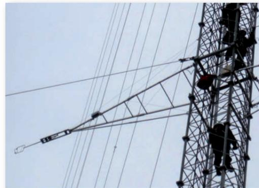
3D Ultraschallanemometer für hochauflösende Turbulenzmessungen.
