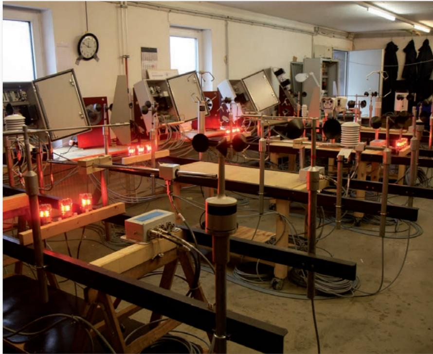
Vor der Installation wurden alle Datenlogger und Sensoren einem Test unterzogen.
